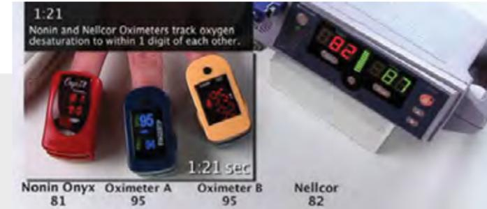
Für einen Hypoxie-Test wurden einem Probanden drei verschiedene Fingerpulsoximeter und ein Tischpulsoximeter angelegt, der eine Minute lang über ein handelsübliches Rebreather\* atmete.
